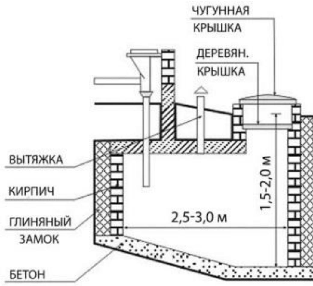
Рисунок 16 Схема устройства выгребной ямы из бетона.
