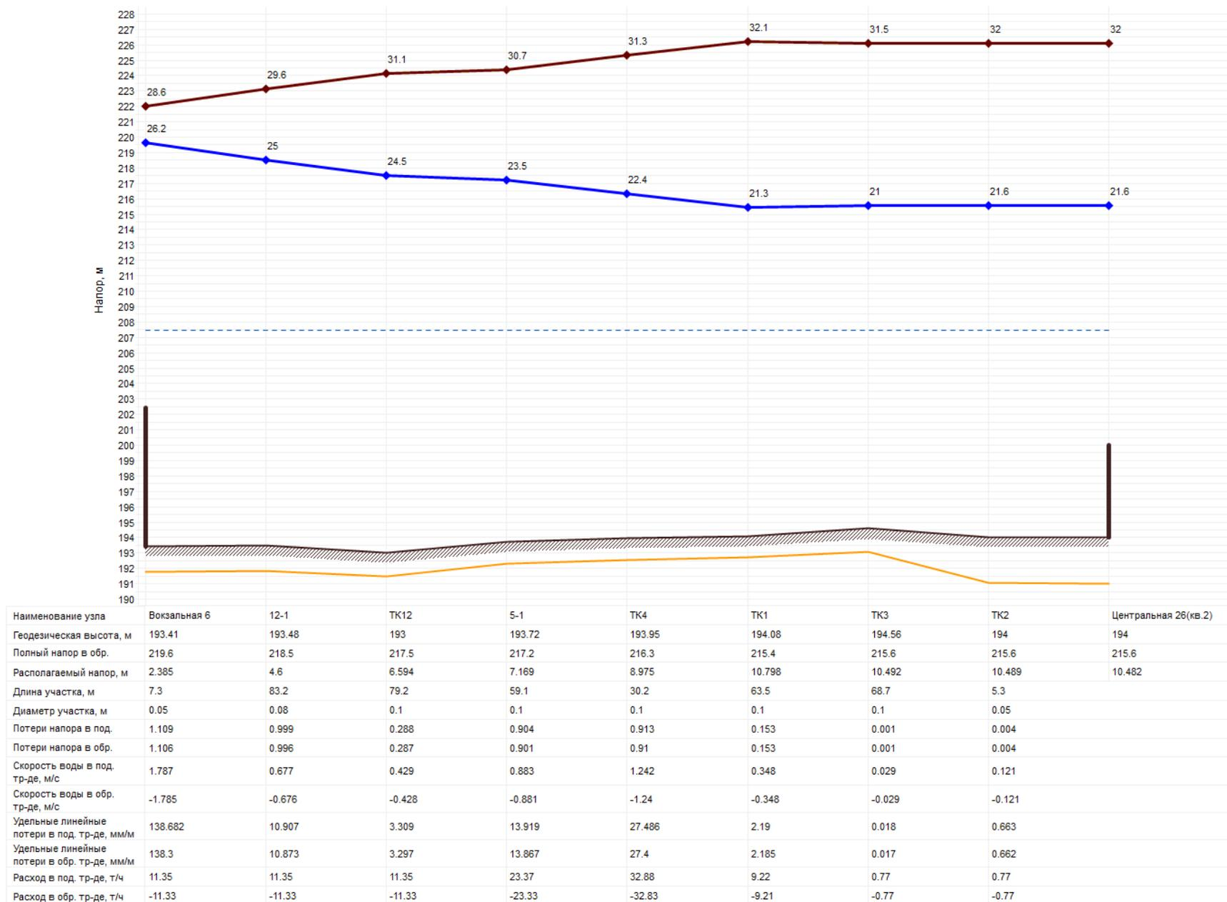
Рисунок 6 Пьезометрический график №2 СЦТ «ж/д ст. Муслимово».
