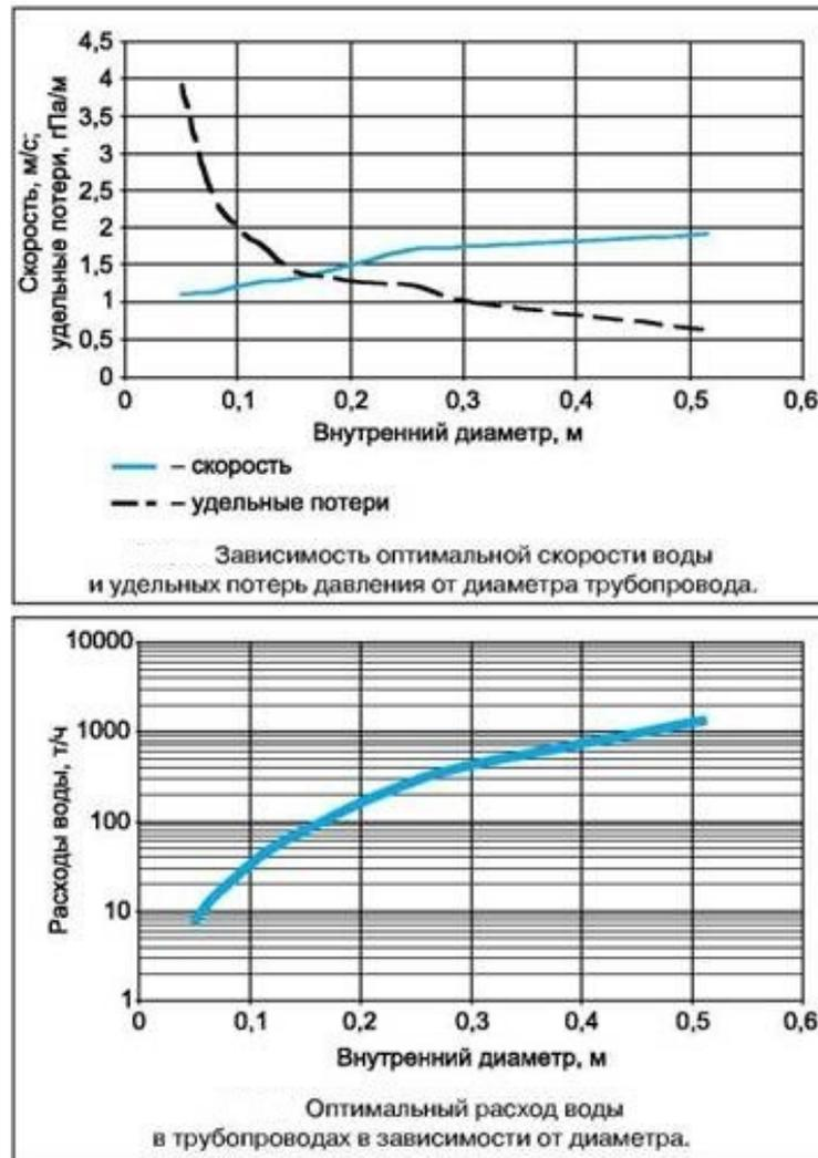
Рисунок 16 Зависимости оптимальной скорости воды от диаметра труб
