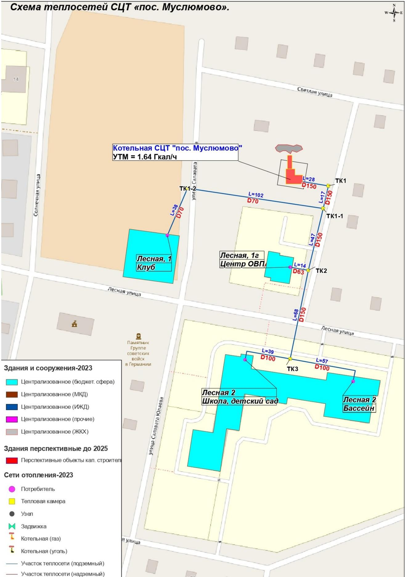
Рисунок 4 Схема сетей теплоснабжения ЦТ «пос. Муслимово».
