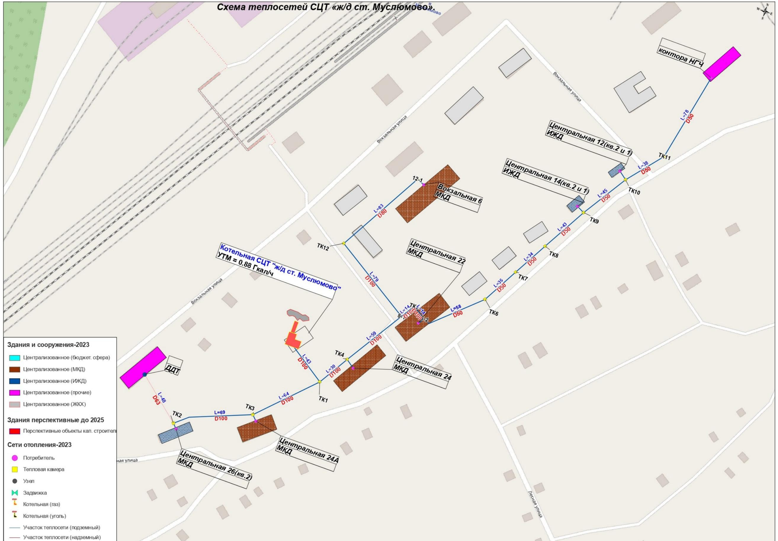
Рисунок 3 Схема сетей теплоснабжения СЦТ «ж/д ст. Муслимово».
