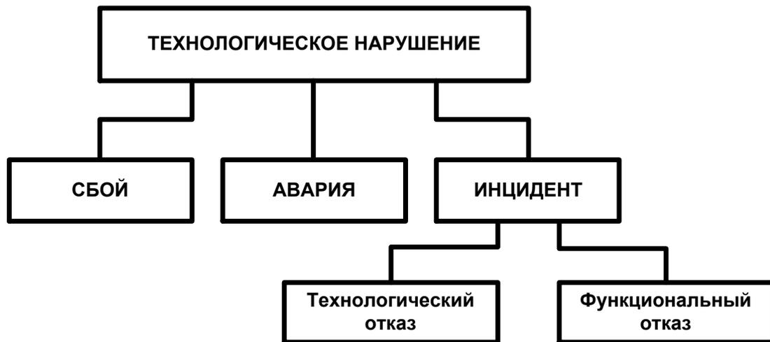
Рисунок 9 Виды технологических нарушений в тепловых сетях.
