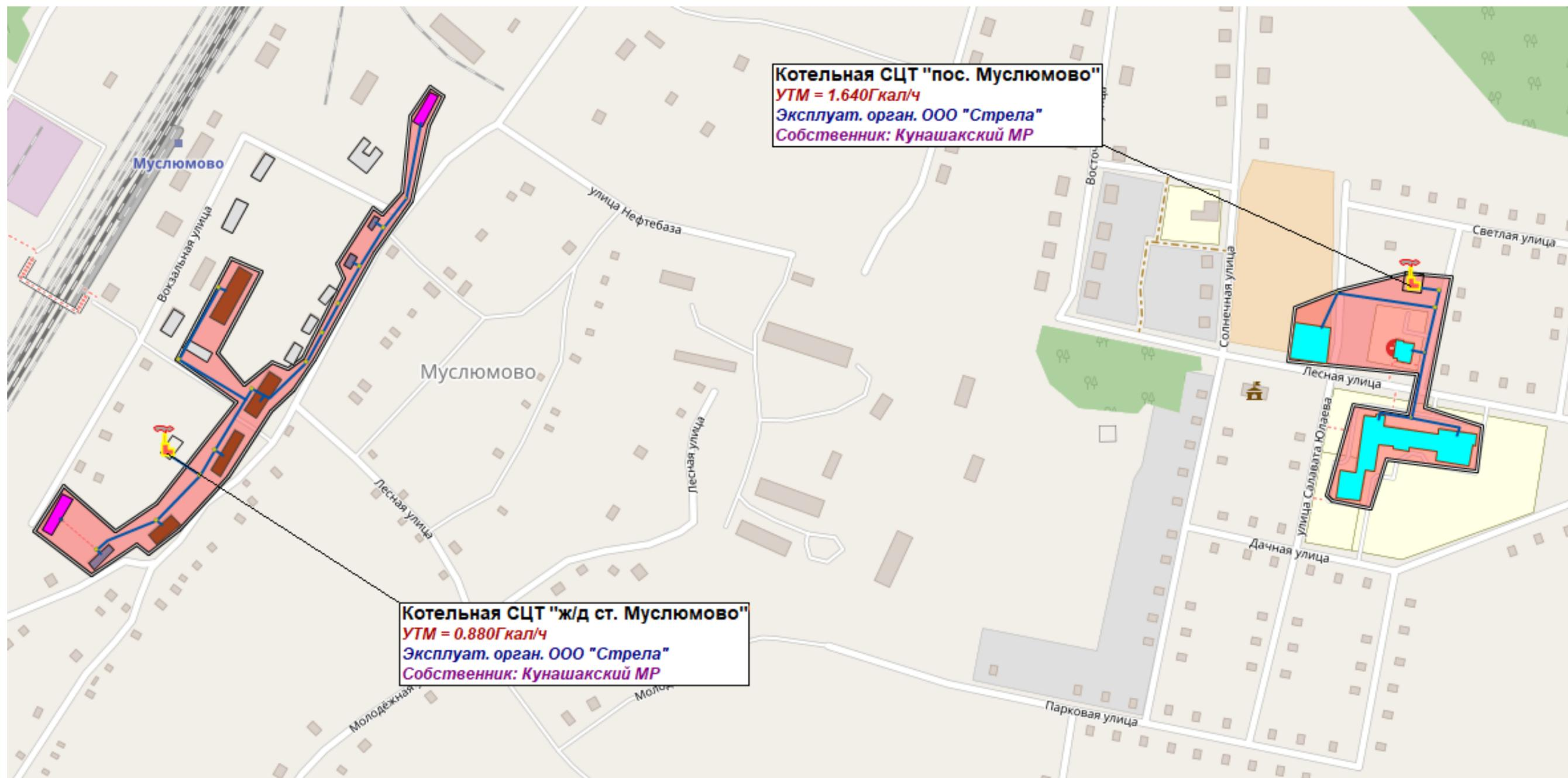
Рисунок 2 Зоны действия систем теплоснабжения и расположение котельных в п. Муслимово ж.д.ст.
