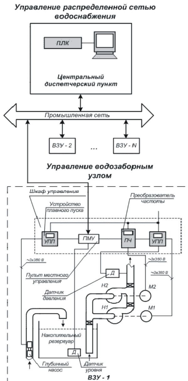
Рисунок 10 Примерная функциональная схема автоматизации объектов ЦСВ
