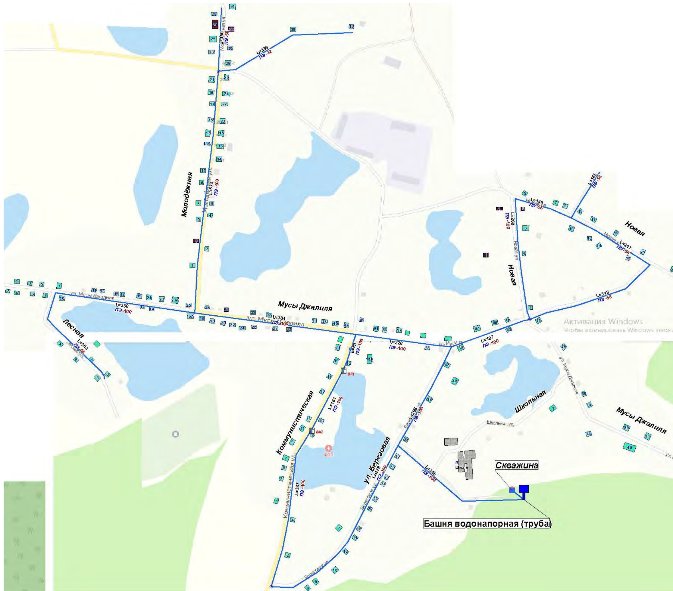
Рисунок 7 Схема сетей ЦСВ «Борисовка».
